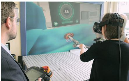
Gemeinsam mit Partnern entwickelt die Professur für Werkzeugmaschinen und Umformtechnik der TU Chemnitz im Rahmen des Projekts „HüftimplantatPfannefräsSimulator“ (HIPS) eine Anwendung zur Simulation einer der anspruchsvollsten Schritte während einer Operation für einen Hüftgelenkersatz: das Ausfräsen des sogenannten Acetabulums (Hüftpfanne).
