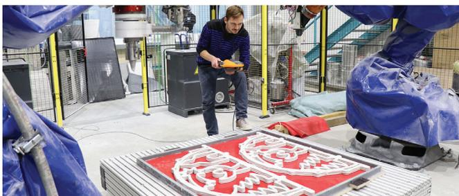
Das Team des Forschungsbereichs „Leichtbau im Bauwesen“ am Institut für Strukturleichtbau der TU Chemnitz fertigte den weltweit ersten Schwibbogen mittels 3D-Betondruck. Der 120 cm breite, 60 cm hohe und 14 kg schwere Schwibbogen wurde mittels zweier Roboter additiv konstruiert.
